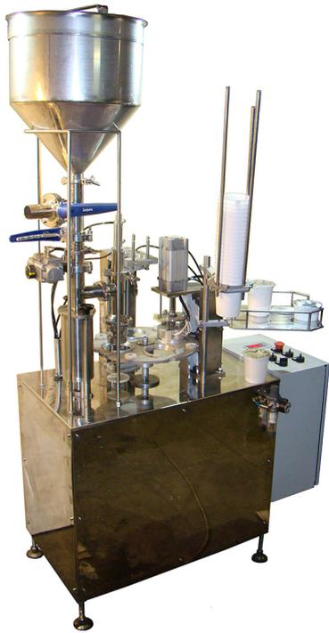
Полуавтомат заправки фасовки в стакан АФ-600 для розлива жидкости в стаканы
